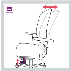
**5 Dynamische Rückenlehne:** (Linken Hebel nach oben klappen.)
