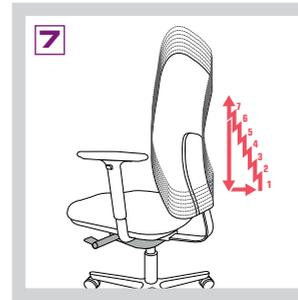
**7 Höhe der Lordosenstütze:** (Die Rückenlehne lässt sich durch eine Auf-/Abbewegung in 7 Stufen höher stellen. Nach der 7. Stufe lässt sich die Lehne wieder in die unterste Position bringen.)
